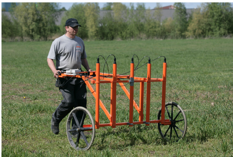
MS-5 computerondersteund multisensor systeem
