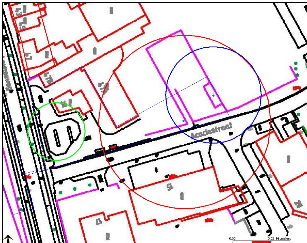
Figuur 4.1: rode cirkel: PR contour 10^{-6} /jaar vulpunt (45 m), blauwe cirkel: PR contour 10^{-6} /jaar ondergrondse tank (25 m), groene cirkel: PR contour 10^{-6} /jaar afgifte zuil (15 m).
