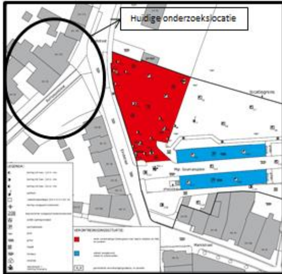
Figuur 1. Locatieschets. Rood: sterk verontreinigd (heterogeen) met zware metalen en PAK, te saneren. Blauw: asbest aangetoond, nader te onderzoeken.
