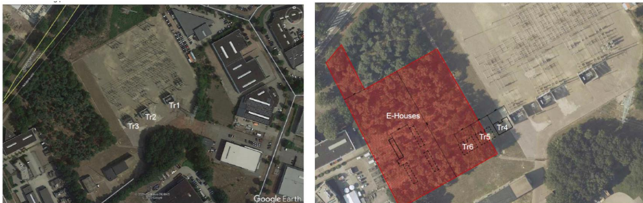
Figuur 2. Satellietbeeld van de huidige situatie met drie transformatoren (links) en de toekomstige situatie met de beoogde uitbreiding (rechts).
