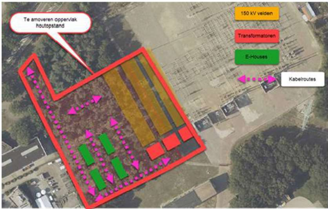
Figuur 3 Voorgenomen ingreep uitbreiding hoogspanning station
