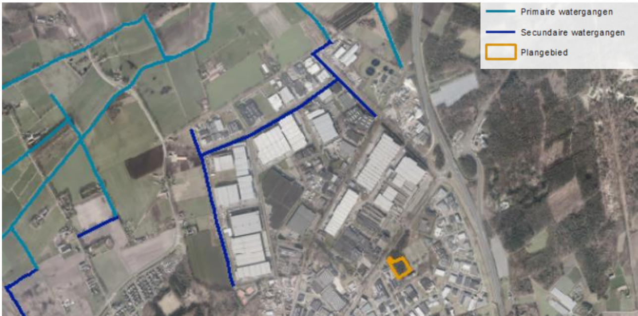
Figuur 5 Huidig oppervlaktewatersysteem in de omgeving van het HS-station
