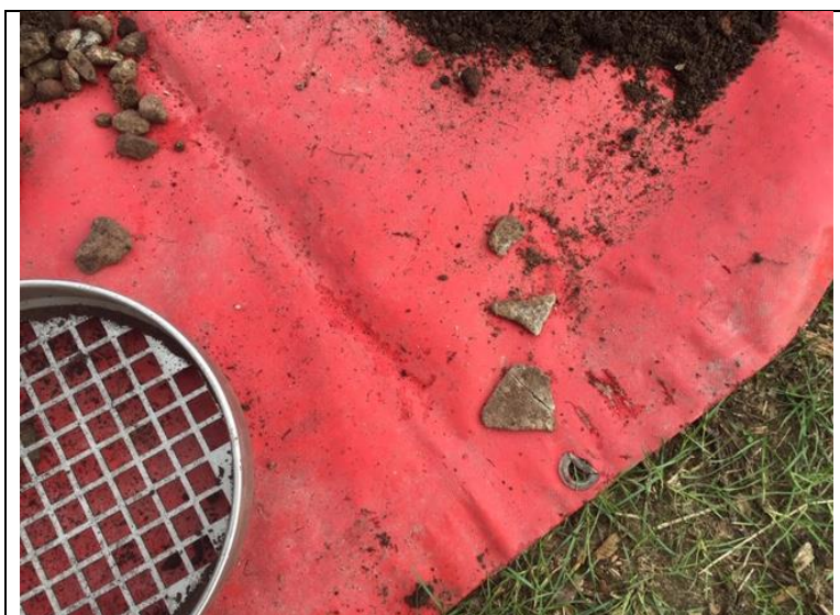
Foto 11: aangetroffen asbest (2 oktober 2020)
