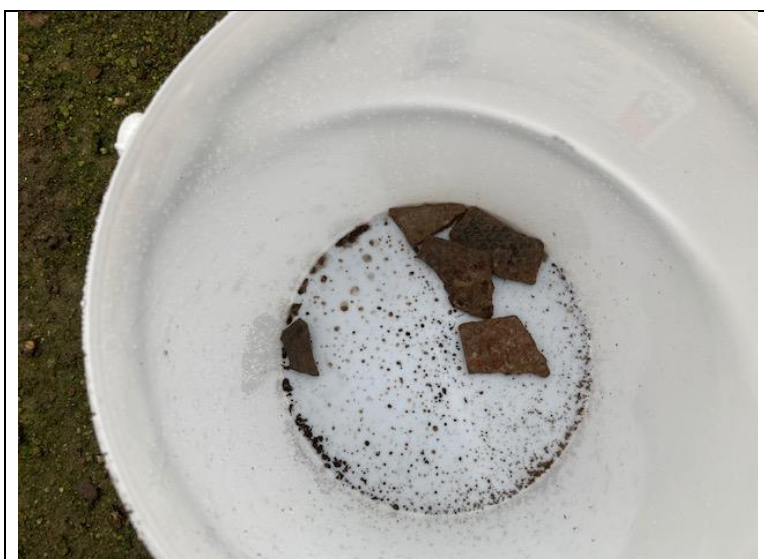
Foto 3: aangetroffen asbest proefsleuf 2 (23 december 2020)
