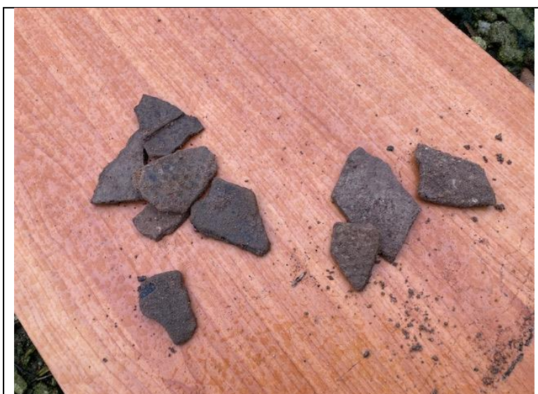
Foto 9: aangetroffen asbest proefsleuf 5 (23 december 2020)
