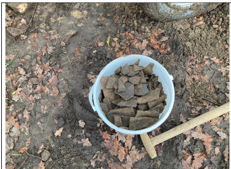
Foto 7: aangetroffen asbest proefsleuf 4 (23 december 2020)
