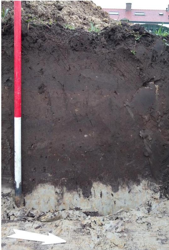
Figuur 9. Profiel 1.4.1. Het gelaagde esdek, de donkerbruigrijze bouwvoor in de natuurlijke bodem en de lichtgrijze natuurlijke ondergrond zijn goed van elkaar te onderscheiden.
