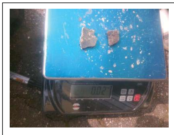
Asbestverdacht plaatmateriaal gat A09
