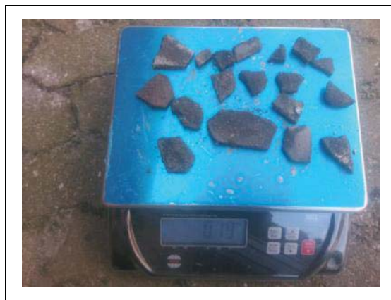
Asbestverdacht plaatmateriaal gat A10
