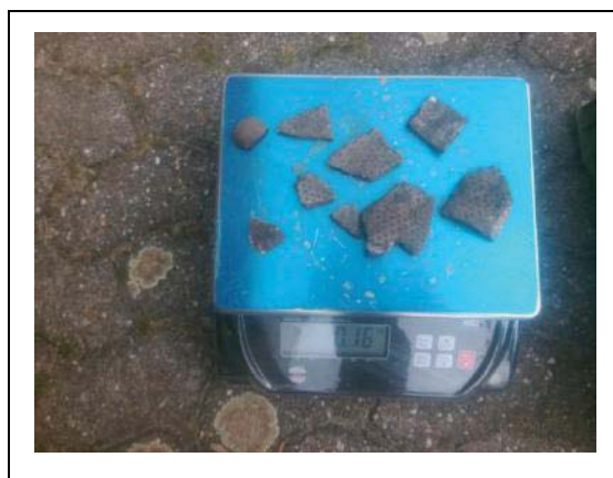
Asbestverdacht plaatmateriaal gat A11
