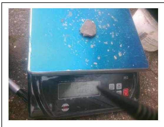
Asbestverdacht plaatmateriaal gat A09
