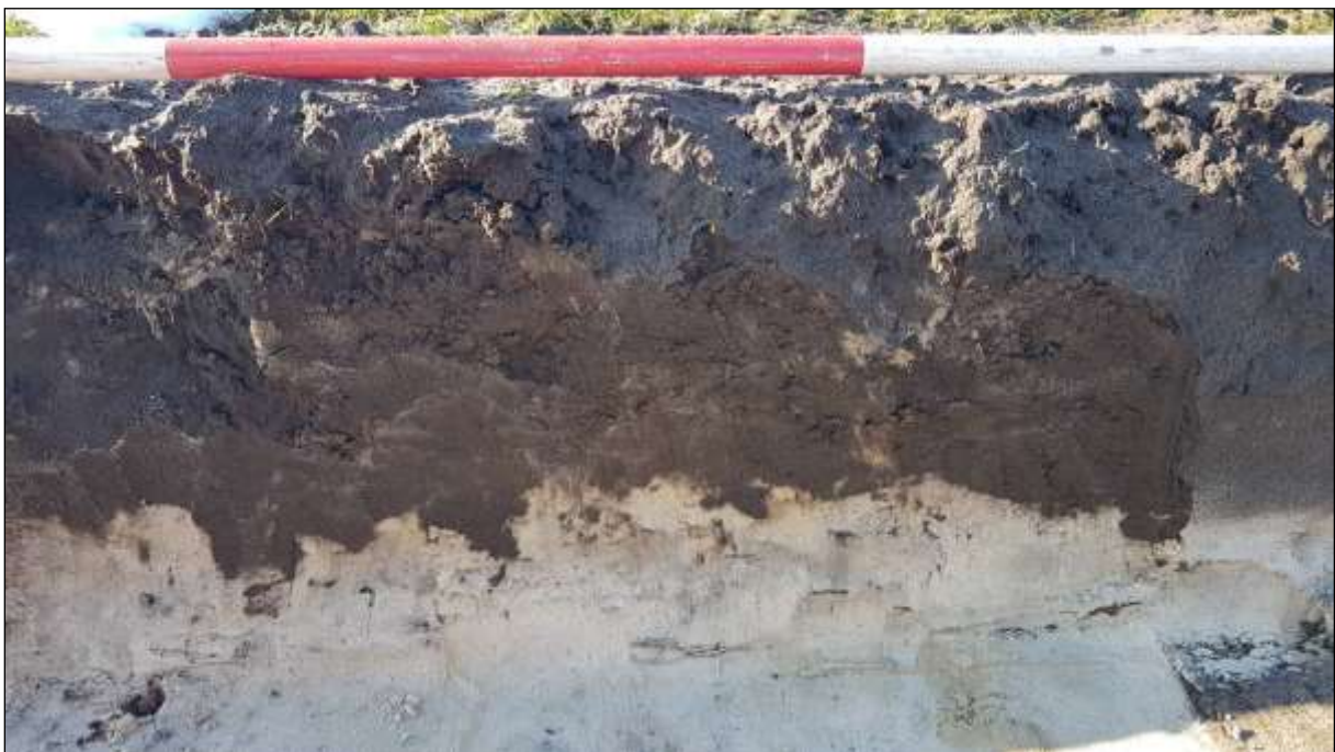
Figuur 27: Bodemprofiel in ontgravingswand nabij boring 14 ter plaatse van het zuidoostelijke deel van het plangebied.
