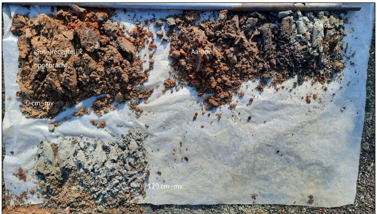
Figuur 6. Foto van boring 4. De leesrichting is van linksboven naar rechtsonder (0- 120 centimeter) (Foto: 22 maart 2022).
