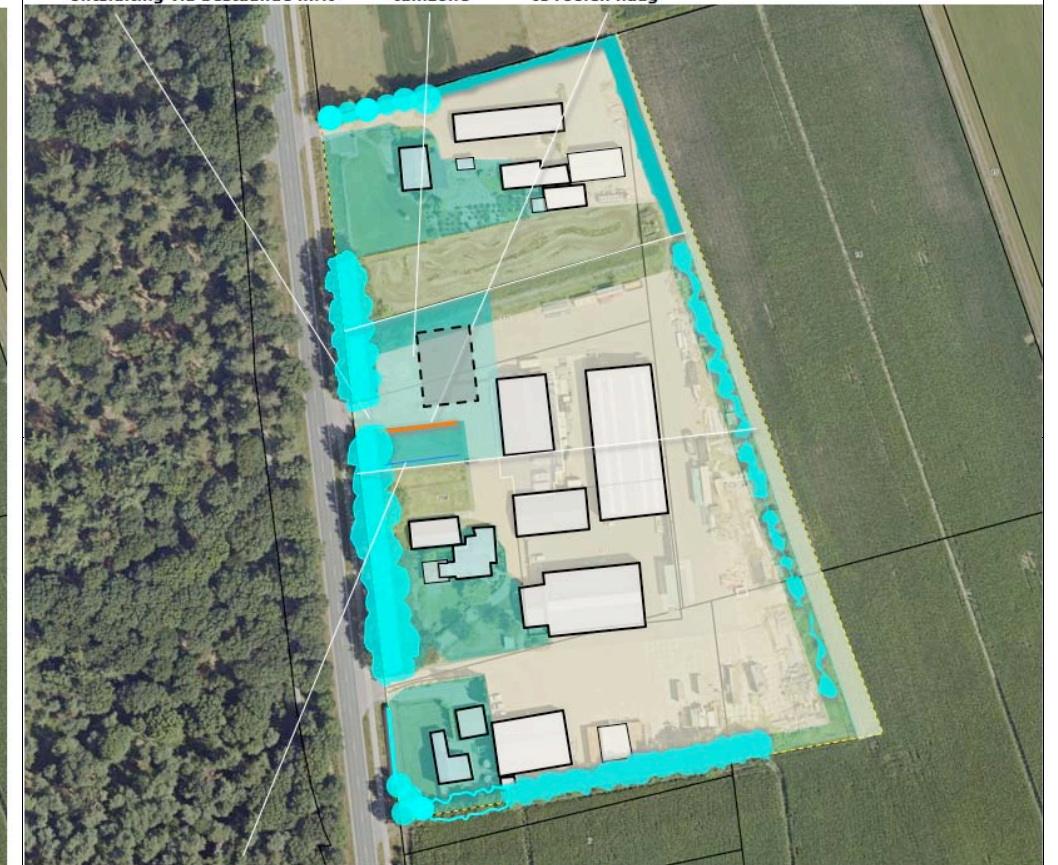
infiltratie in een greppel of ondergrondse voorziening
