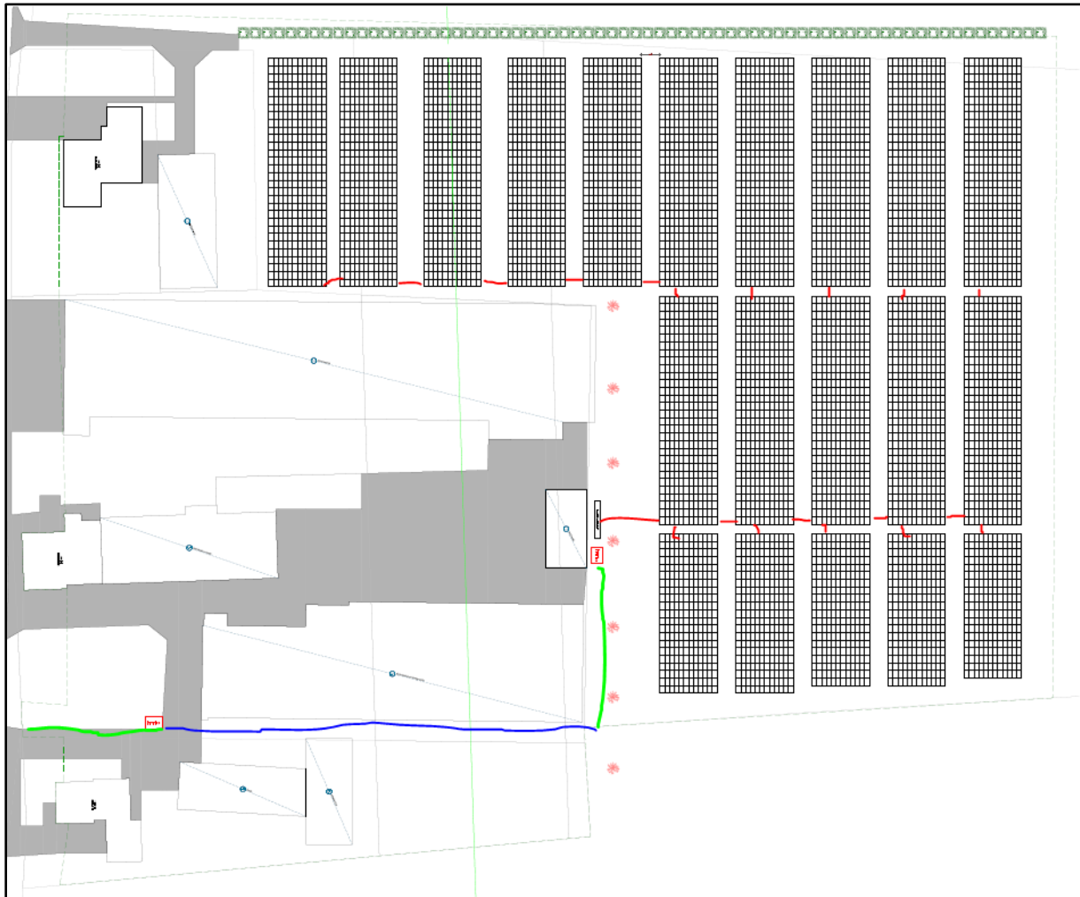
Figuur 5.3: graafwerkzaamheden voor bekabeling onder de paden (compartimenten)
