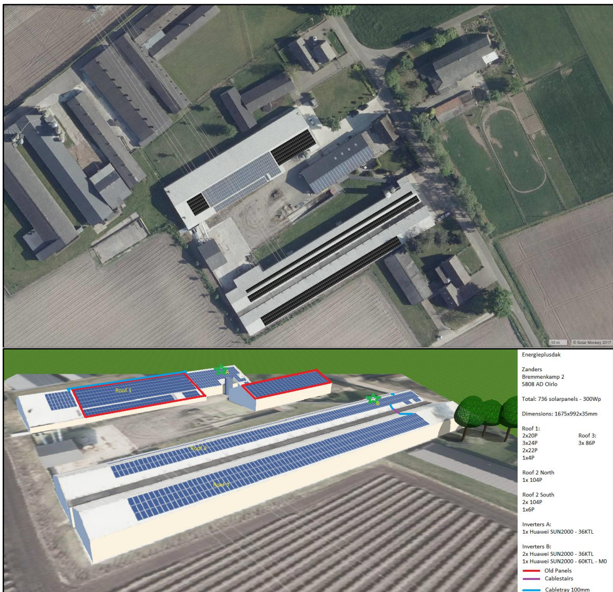
Figuur 3.2: gerealiseerde panelen en animatie gerealiseerde zonnepanelen op staldaken
