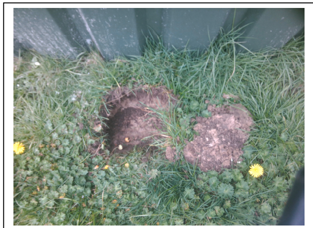
Foto 1. Asbestinspectiegat met opgegraven materiaal Sp1-1
