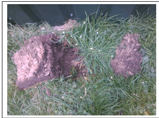
Foto 2. Asbestinspectiegat met opgegraven materiaal Sp1-2
