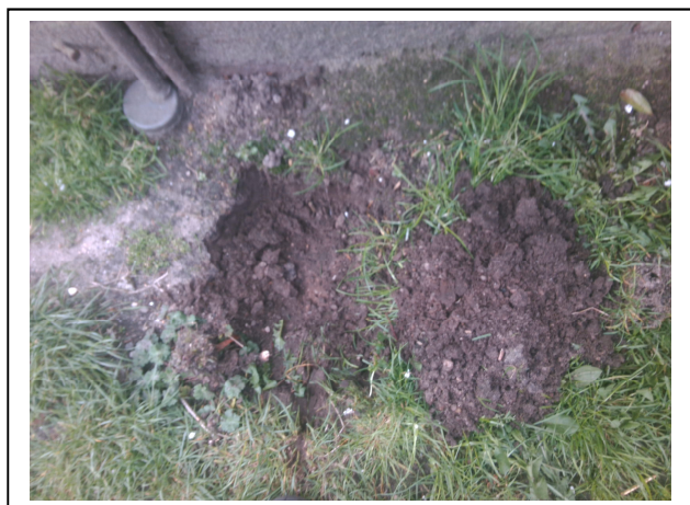
Foto 3. Asbestinspectiegat met opgegraven materiaal Sp2-1
