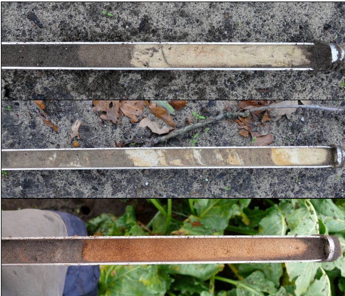
Afbeelding 16. Enkele voorbeelden van boorprofielen. Van boven naar beneden: een getopt profiel waarin de A-Horizont direct op de C-horizont ligt, een profiel dat gediepploegd is en een getopt profiel, waarin het bovenste deel van de B-horizont ontbreekt. Het betreft hier een redelijk diep ontwikkelde B-horizont die geleidelijk via een BC overgaat in de C-horizont.
