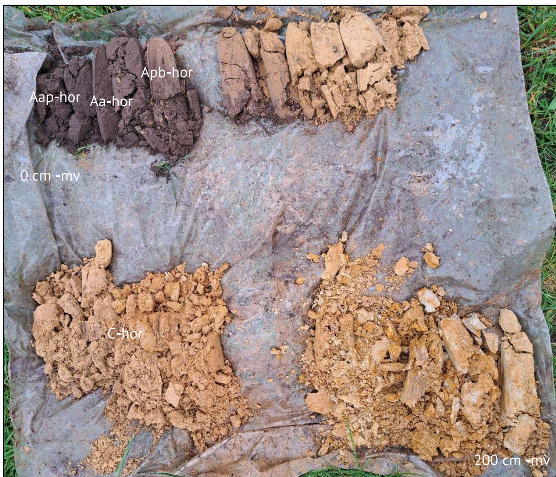
Figuur 6. Foto van boring 1. De leesrichting is van linksboven naar rechtsonder (0 - 200 centimeter) (Foto: 15 februari 2024).
