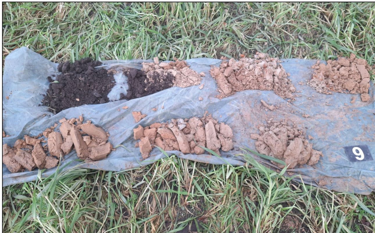
Afbeelding 6: Foto van profielboring 09 uitgelegd per halve meter van links boven naar rechts onder
