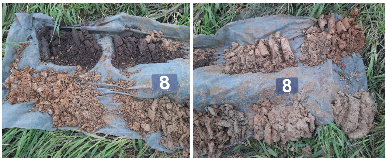
Afbeelding 5: Foto's van profielboring 08 uitgelegd per halve meter van links boven naar rechts onder met op de rechtse foto onderaan duidelijk de leemlaag
