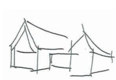
Combinatie gebouwen. Hoofdvolume met zadeldak en overstek, geschakeld platdak
