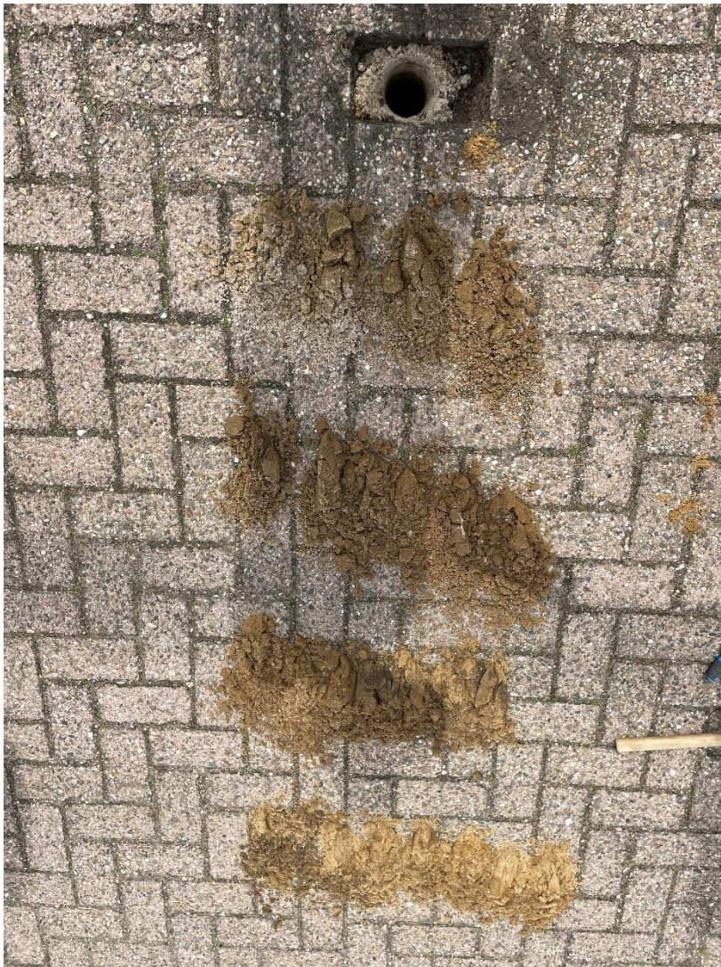
Figuur 18 Boring 4 te lezen van links naar rechts en boven naar beneden
