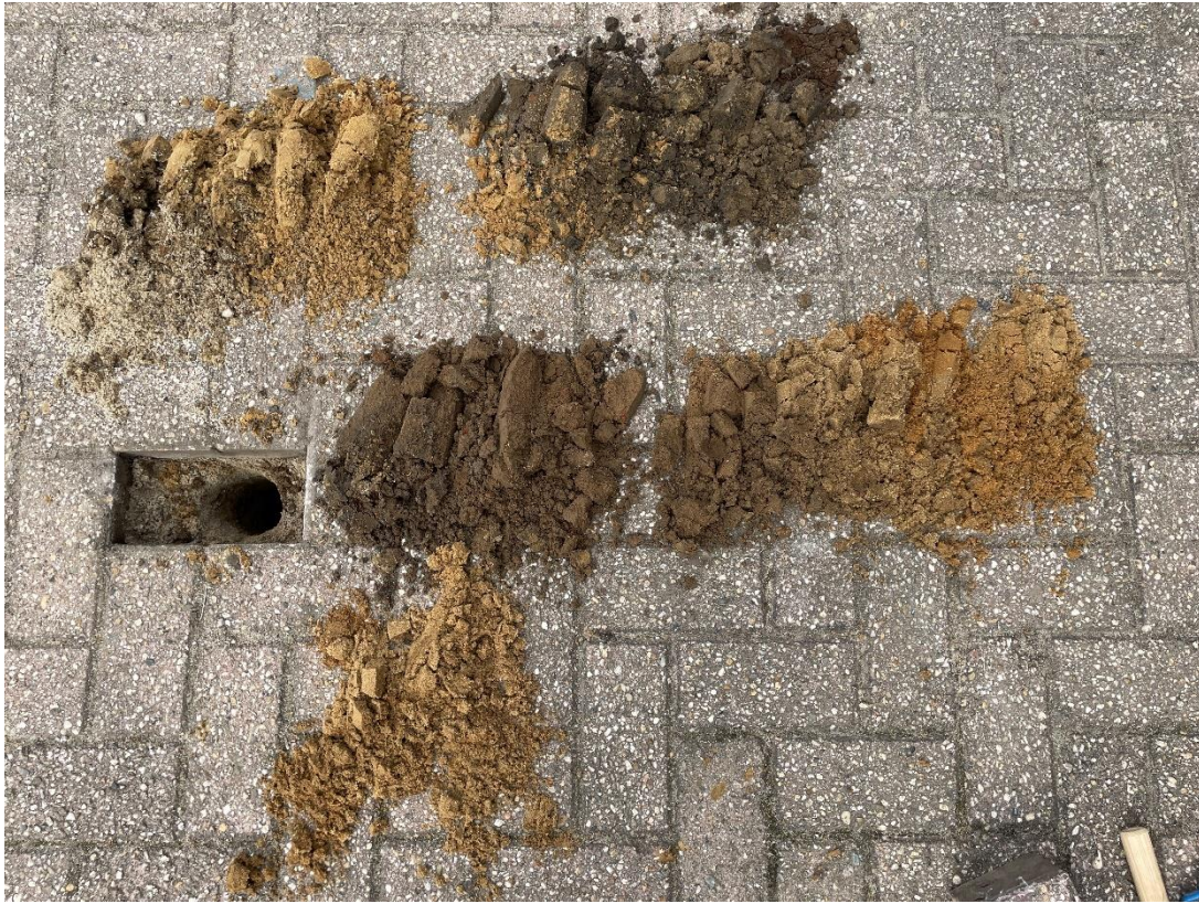
Figuur 16 Boring 2 te lezen van links naar rechts en boven naar beneden
