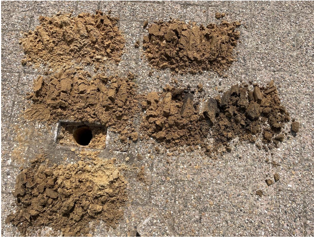
Figuur 19 Boring 5 te lezen van links naar rechts en boven naar beneden
