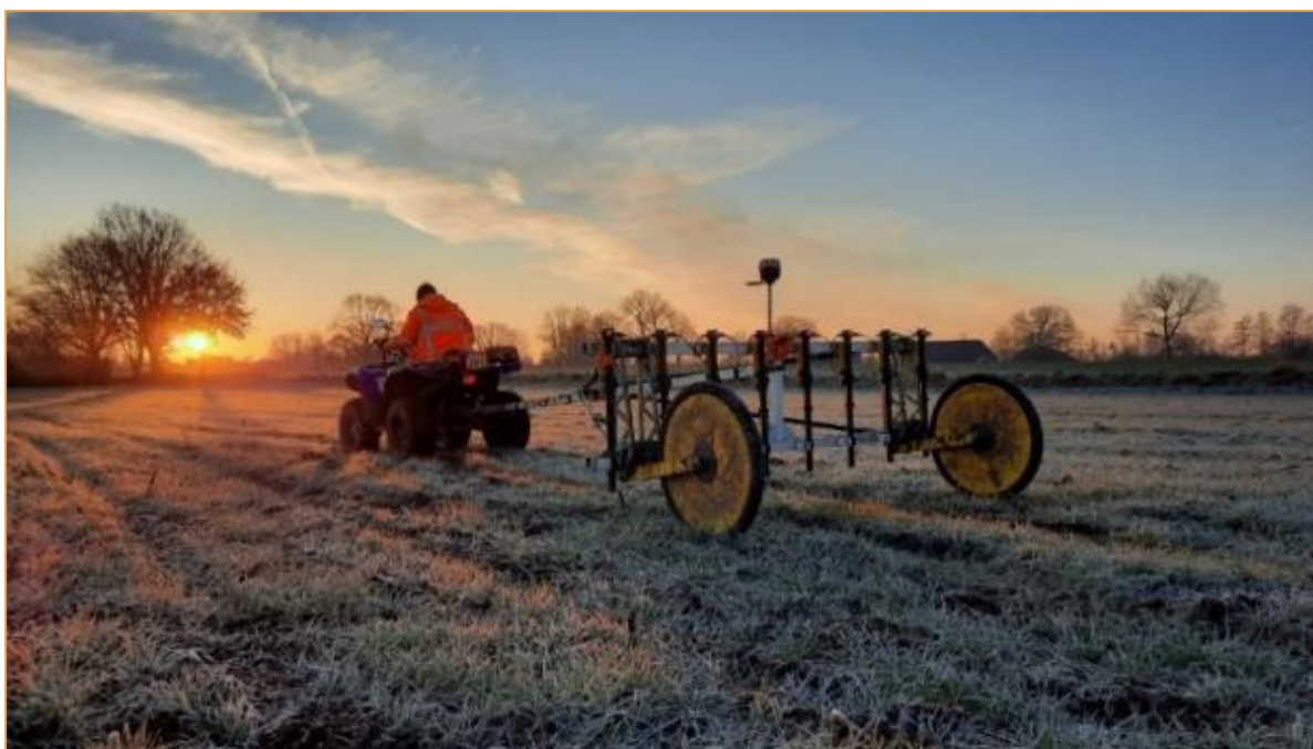
Afbeelding 2: Detectie met behulp van multisonde (Bron: Euroradar).
